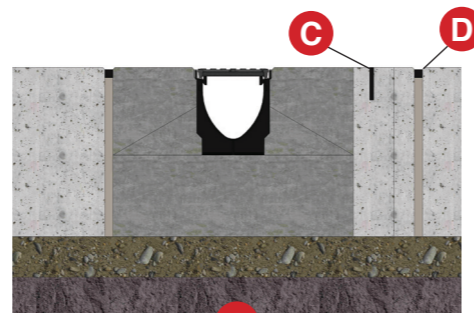
Pose en chaussée béton
