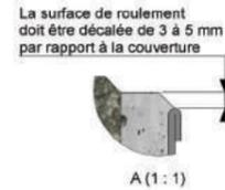
Les pavés à proximité du caniveau doivent être scellés. Le nombre de pavés scellés doit correspondre au minimum à la largeur X.
