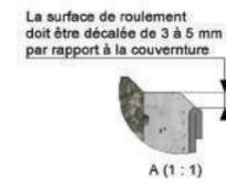
Les pavés à proximité du caniveau doivent être scellés. Le nombre de pavés scellés doit correspondre au minimum à la largeur X.
