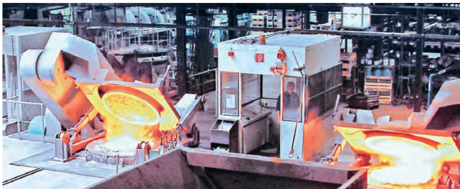
Fours de fusion modernes à induction moyenne fréquence, ACO Kaiserslautern
